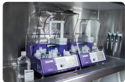
RoboSep™-Sは非常にコンパクトで蓋を取り外して、クリーンベンチに置くことも可能です。
