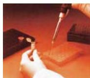
2. DNA と D-mix のミクスチャー溶液を各ウェルに 10μL ずつ分注 (陰性コントロールウェルを除く)
