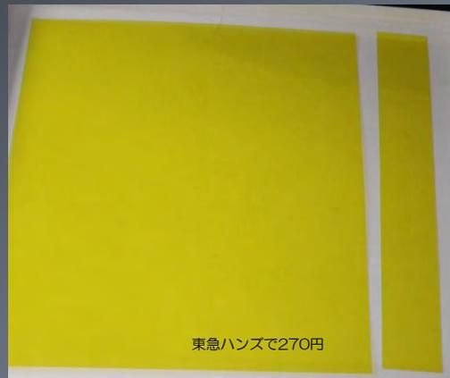
0.5mm程度の半透明色シートを用いてフィルムと同時に取り込み、ADC値の変化を見る
