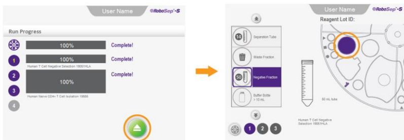
図 22. プロトコル実行が完了して単離細胞を回収する: 目的の単離細胞は Unloading 画面の四分画領域 1 にカラーで強調表示されているチューブ内にあります。
