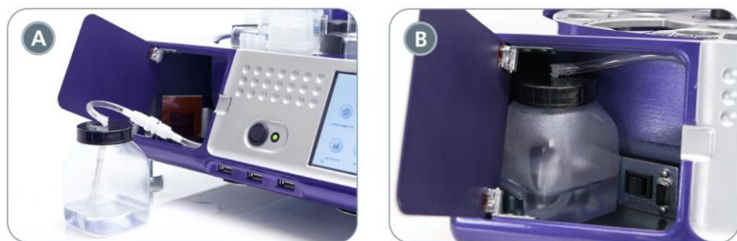
図 13. 水圧系: 圧力水ボトルとクイックリリース —(A)装置の外と(B)装置の中
