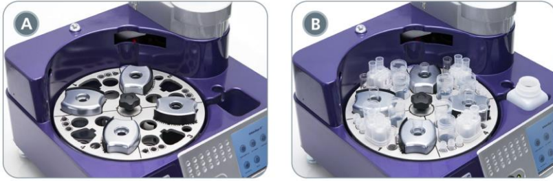
図 5. 回転式作業台: 四分画領域全体、(A)空の状態と(B)ロードされた状態。
