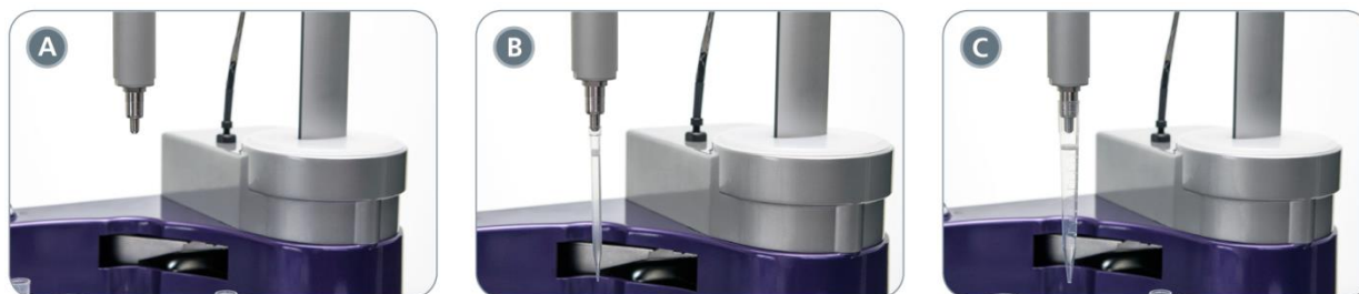
図 4. ロボットアームのチップヘッド: (A)チップを拾う前のチップヘッド、(B)使い捨ての 1 mL チップを拾った後、(C)使い捨ての 5 mL チップを拾った後
