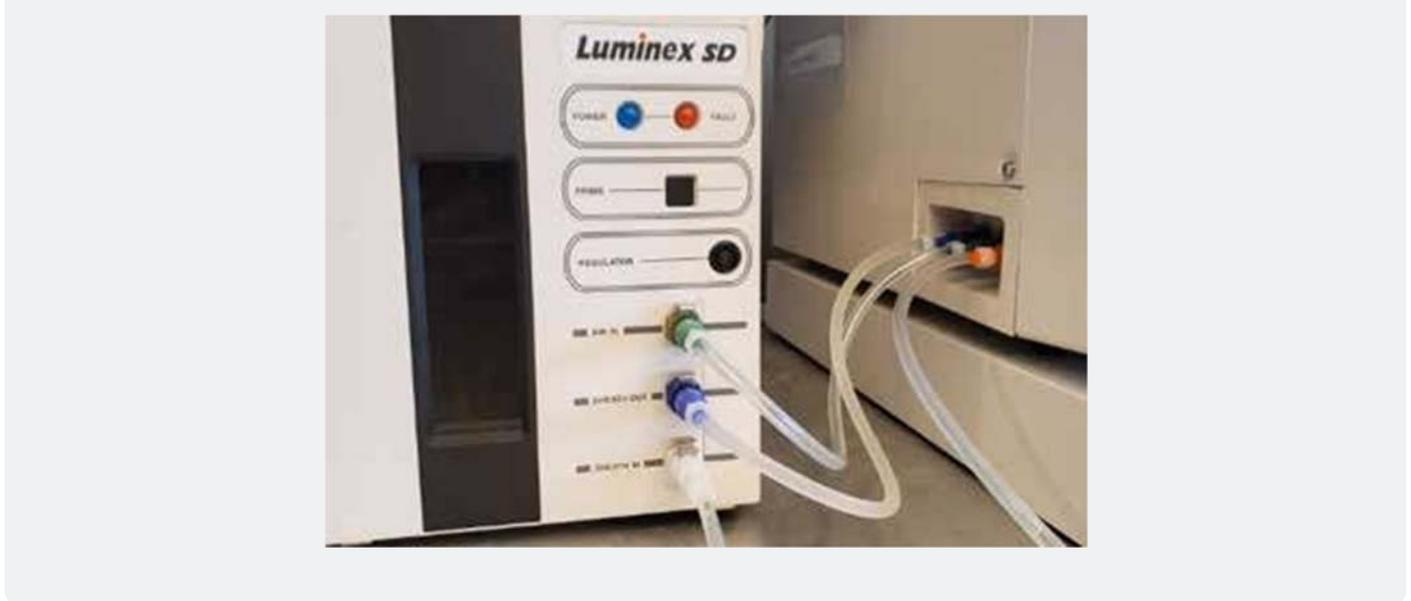
5. 制御ソフトウェアでPrime 6回・Backflush 8回・Wash 3回を実行し、古いシーブ液をアナライザーの流路からパージします。
