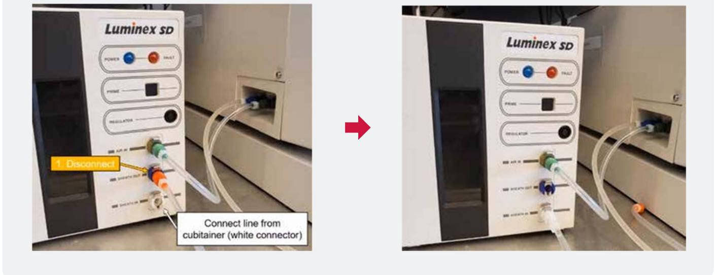
4. SD の充填が完了したら、すべてのチューブを元の位置に戻します。(図 3 を参照)
