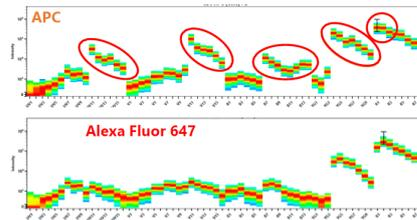
Cytekのフルスペクトラルフローサイトメーターは特定の波長領域ではなく、全波長領域で蛍光を取得後、スペクトルの違いに基づいて各蛍光を識別します。そのため、従来法に比べて蛍光色素の識別能力が各段に向上し、APCとAlexa Fluor647の識別が可能です。さらに、従来の蛍光補正作業の負担が軽減するため、マルチカラー解析をより簡便、正確に行うことができます。
